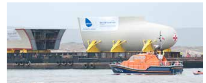
Transporte de la sección de proa del portaaviones «QEC» desde Appledore a Rosyth
