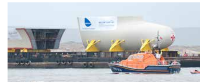
Secção de proa de um porta-aviões QEC a ser transportado de Appledore para Rosyth
